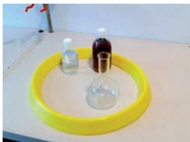
Barrière à utiliser sur une surface lisse : paillasse ou table de laboratoire. Sa structure souple lui permet de s'adapter à chaque situation rencontrée. L'adhésion parfaite de sa base à la surface (lisse) est inhérente au polyuréthane.
