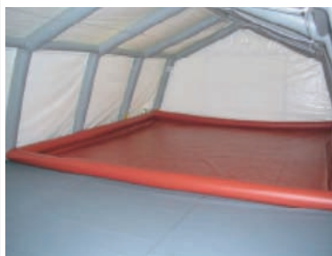
Bassin de décontamination unique dans une tente, évacuation par pompage.
